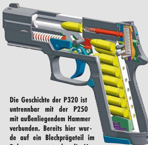
Die Geschichte der P320 ist untrennbar mit der P250 mit außenliegendem Hammer verbunden. Bereits hier wurde auf ein Blechprägeteil im Rahmen gesetzt, das die Verschlussführung übernimmt und die Abzugsteile aufnimmt.
